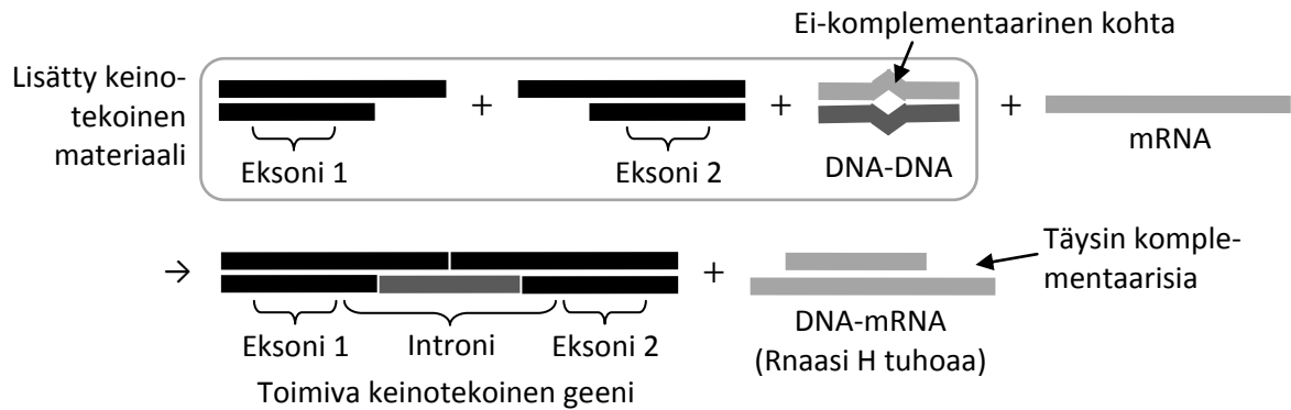
Kuva 14. Laskennallinen geeni (Martinez-Perez et al. 2007), jonka koodaaman proteiinin tuotanto riippuu tietyn mRNA:n läsnäolosta. Epätäydellisesti komplementaarista juosteista koostuvan osin kaksijuosteisen, keinotekoisin diagnoosi-DNA:n ensimmäinen juoste sitoutuu tunnistettavaan mRNA:han, johon nähden se on täydellisesti komplementaarinen. Syrjäytynyt toinen juoste kiinnittää keinotekoisin geenin osat toisiinsa tehden sen toimivaksi. Solun oma RNAasi H tuhoaa mRNA:n, johon on sitoutunut DNA:ta.
